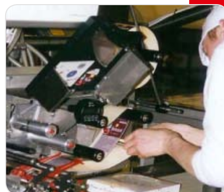
Avec l'ALX 924 les rouleaux d'étiquettes peuvent être changés sans arrêter la ligne de production
